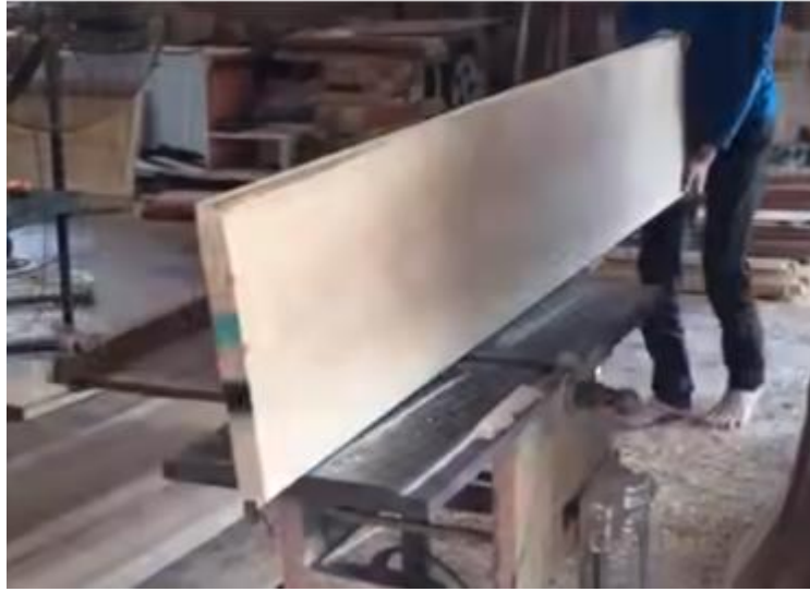
Şəkil 1.49. Pəstahın qıraqlarının yonulması
