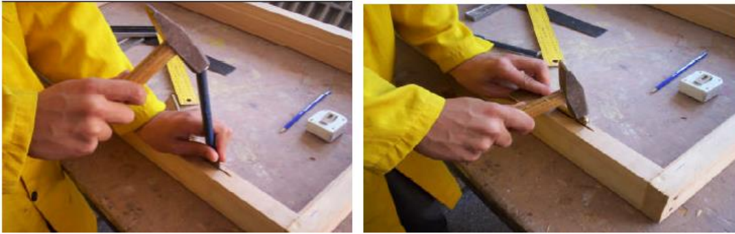
Şəkil 3.33. Toxmaqla həncama izinin laya köçürülməsi
