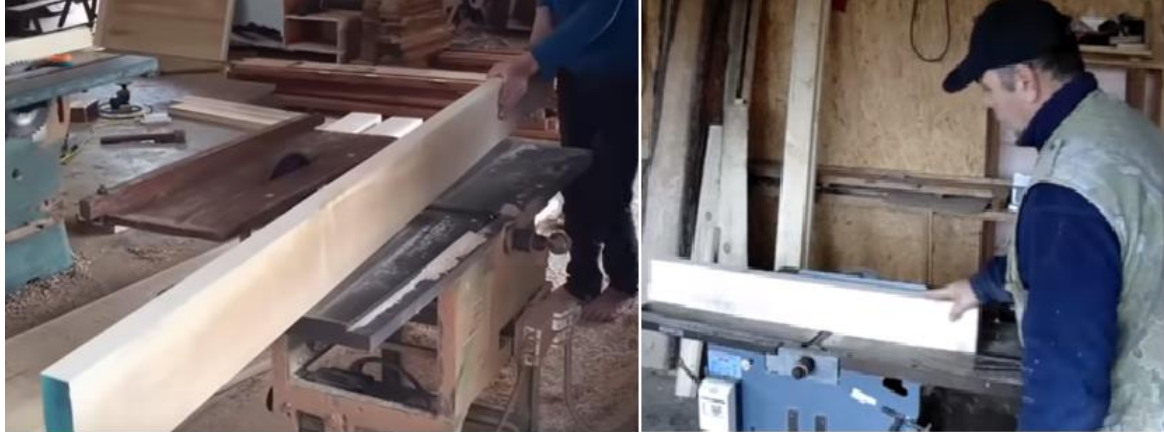
Şəkil 1.51. Taxtanın dörd tərəfdən rəndələnməsi
