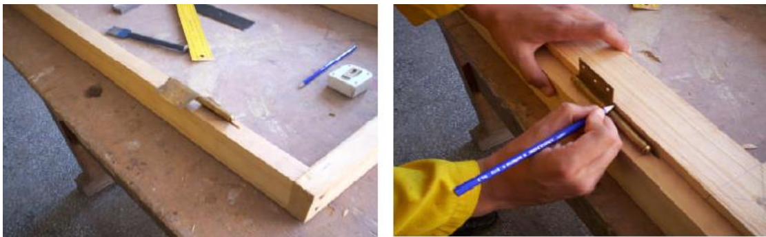
Şəkil 3.34. Həncamaların qoyulması
