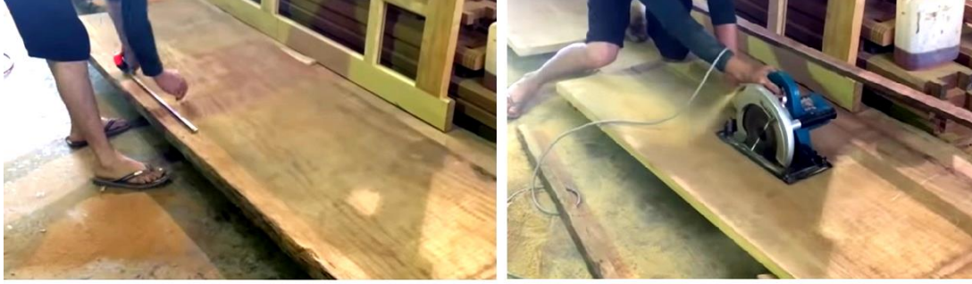
Şəkil 1.71. Xonçalar üçün massiv taxtanın doğranması
