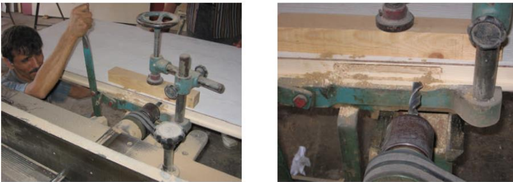
Şəkil 3.20. Kilid yuvasının açılması
