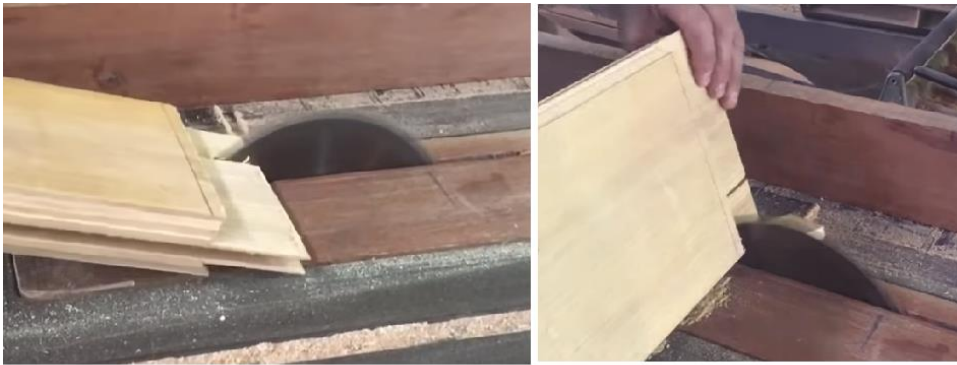
Şəkil 1.68 . Dilçələrin qıraq hissəsinin kəsilməsi
