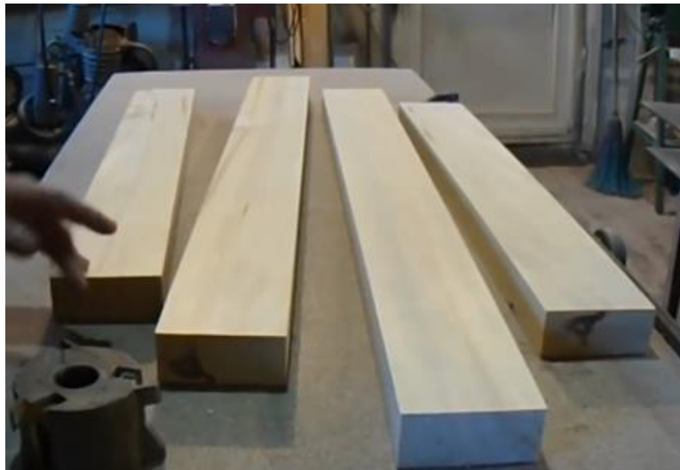
Şəkil 2.25. Brüsların hazırlanması
