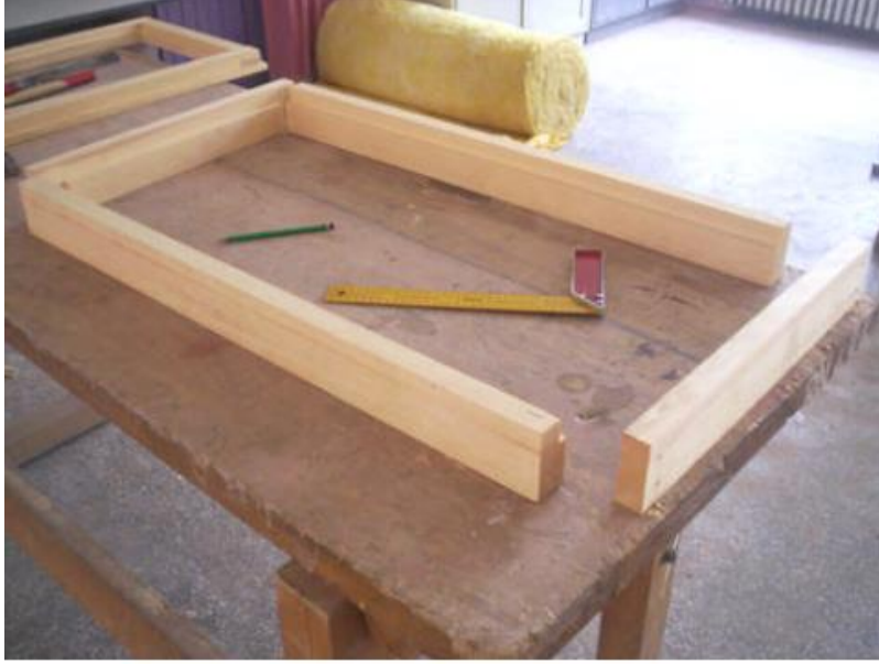
Şəkil 2.28. Pəncərə elementlərinin ölçüləri yoxlanılır
