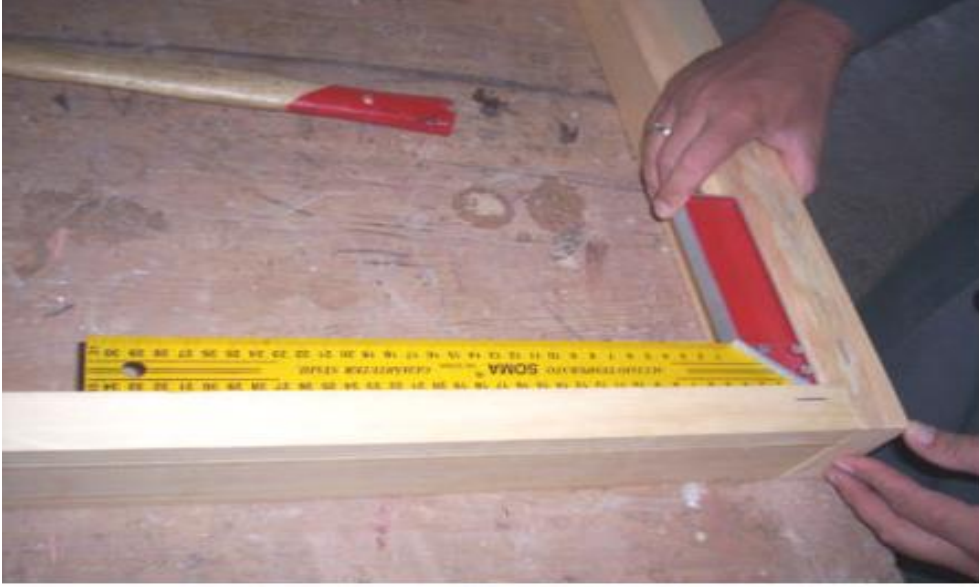
Şəkil 2.32. Çərçivənin küncləri günyə vasitəsi ilə yoxlanılır.
