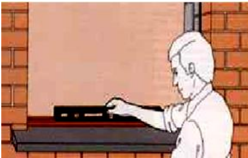
Şəkil 2.51. Pəncərəaltı taxtaların divarda yerinə qoyulması
