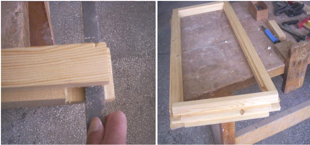
Şəkil 2.40. Lay elementləri birləşdirilir
