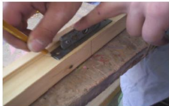
Şəkil 3.36. Kilid mərkəzi tapılır və kilid yuvası nişanlanır
