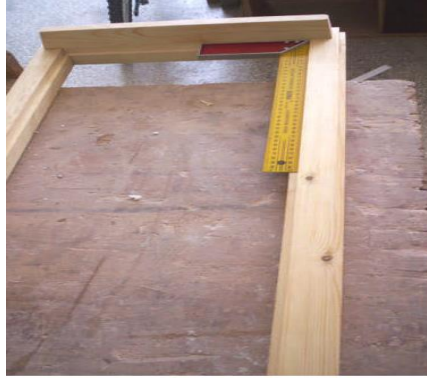
Şəkil 2.48. Layların günyə vasitəsi ilə yoxlanması
