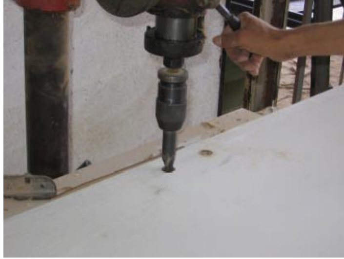
Şəkil 3.21. Kilid içliyi və dəstək milinin yerlərinin deşilməsi
