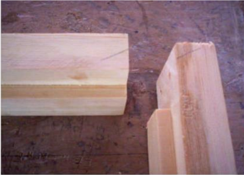
Şəkil 2.29. Uyğun çərçivə birləşməsi hazırlanır
