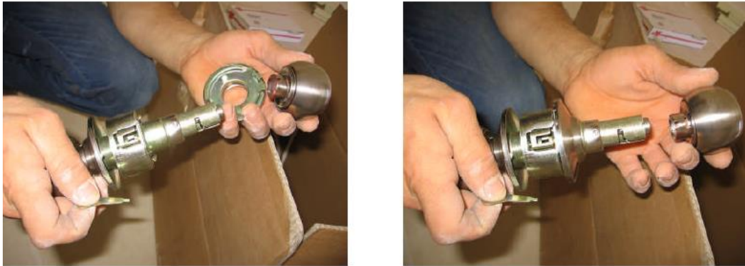
Şəkil 3.24. Kilidin dəstəklərinin açılması
