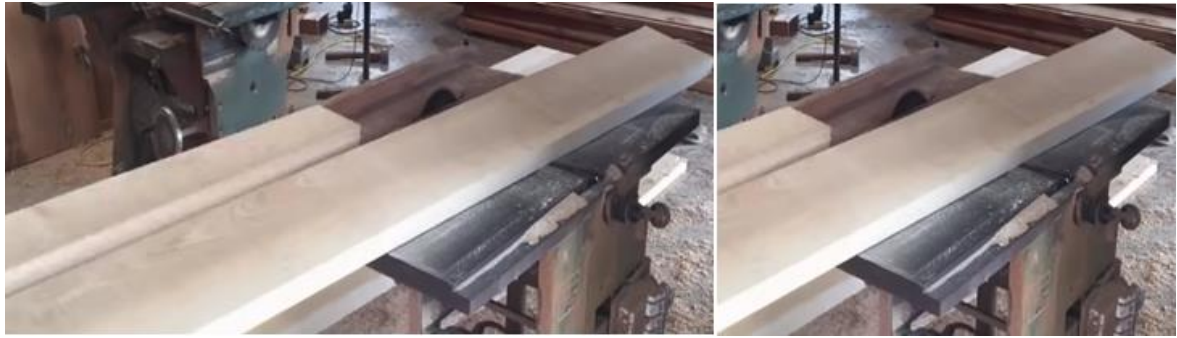
Şəkil 1.50. Taxtaların en ölçülərə görə kəsilməsi
