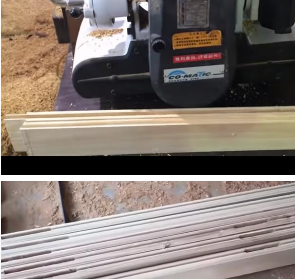
Şəkil 1.67. Xonçaların oturdulması üçün novlar
