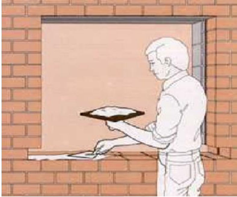
Şəkil 2.50. Divarda pəncərə boşluğunun hazırlanması
