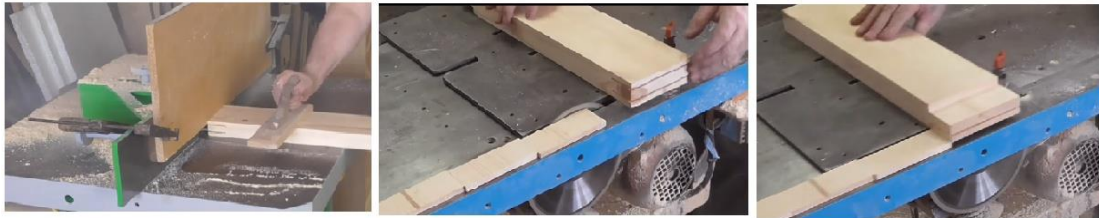
Şəkil 1.65. Dilçələrin dairəvi mişarda hazırlanması
