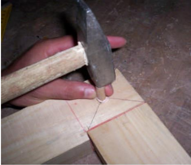
Şəkil 2.45. Nagellər açılmış deşiklərə vurulur
