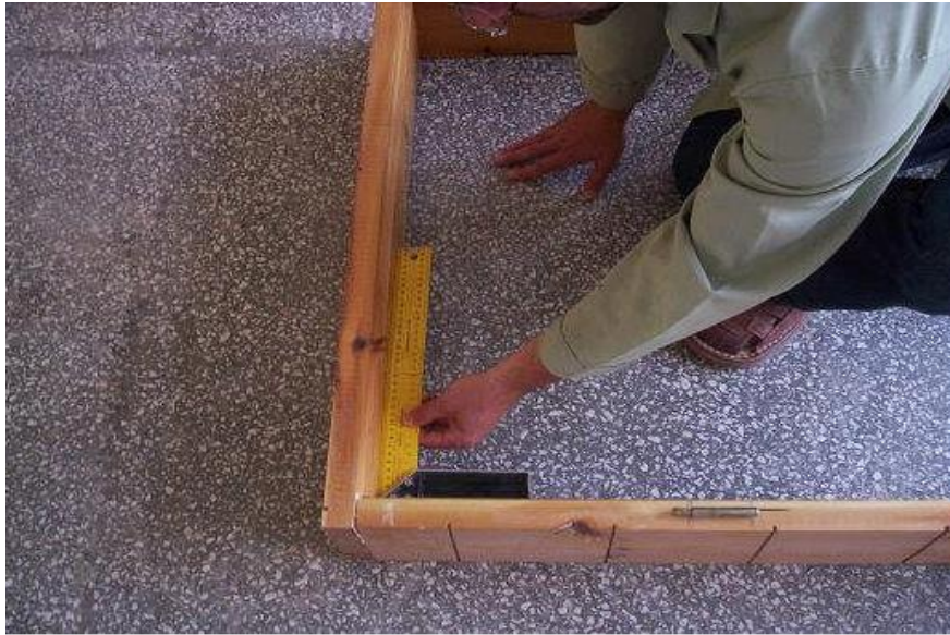
Şəkil 1.57. Çərçivənin günyələnməsi
