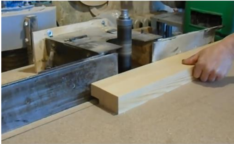
Şəkil 2.27. Çərəklərin çıxarılması
