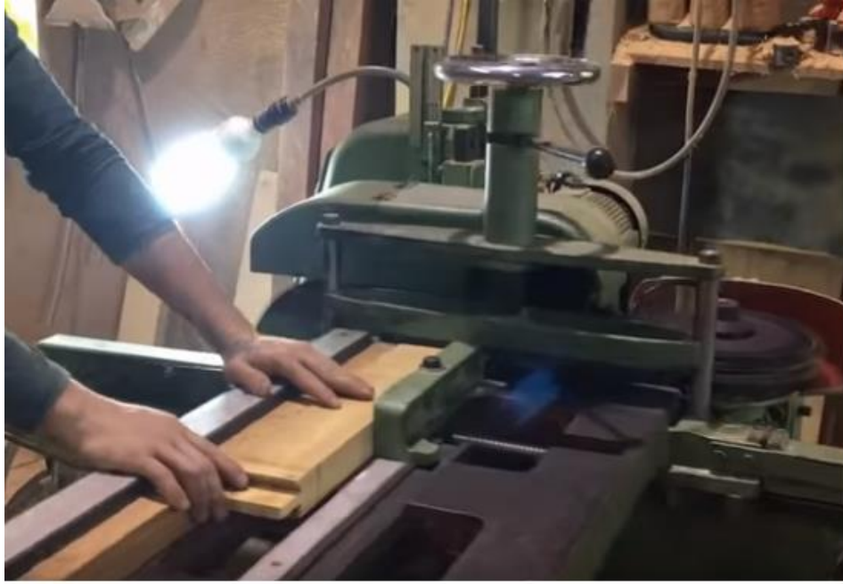
Şəkil 1. 64. Dilçələrin frez dəzgahında hazırlanması
