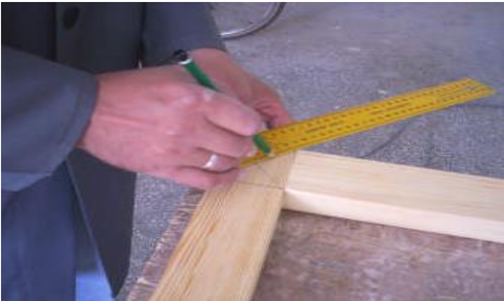
Şəkil 2.42. Layların birləşmə mərkəzləri tapılır
