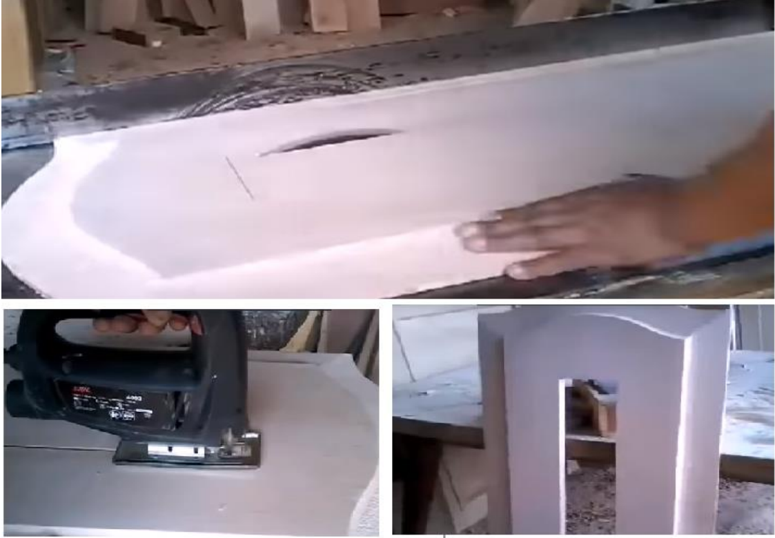
Şəkil 1.81. Şüşə boşluğunun kəsilməsi
