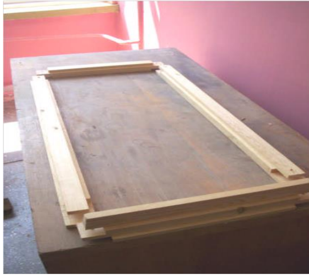
Şəkil 2.39. Layların elementləri montaj stoluna qoyulur
