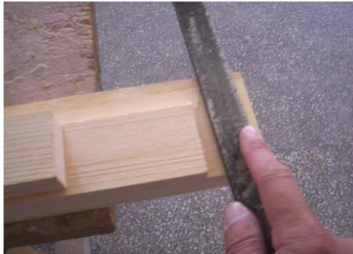
Şəkil 2.30. Birləşmə elementləri dəqiqləşdirilir.
