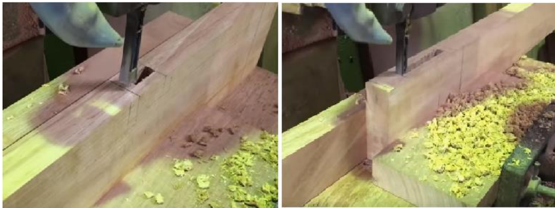
Şəkil 1. 66. Dilçə yuvalarının hazırlanması
