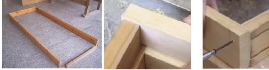
Şəkil 1.56. Çərçivənin düz səthə qoyulması və brusların birləşdirilməsi
